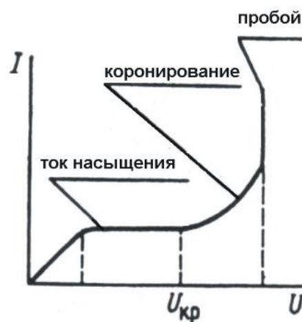
Рисунок 7.2 - Зависимость силы тока от напряжения между электродами
