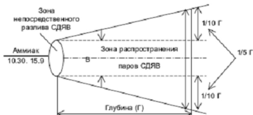
Рисунок 6.1 – Схема очага заражения, образованного СДЯВ
