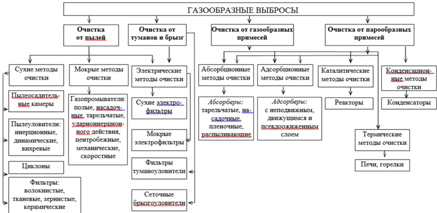
Рисунок 2.1 – Классификация методов и аппаратов для обезвреживания газовых выбросов
