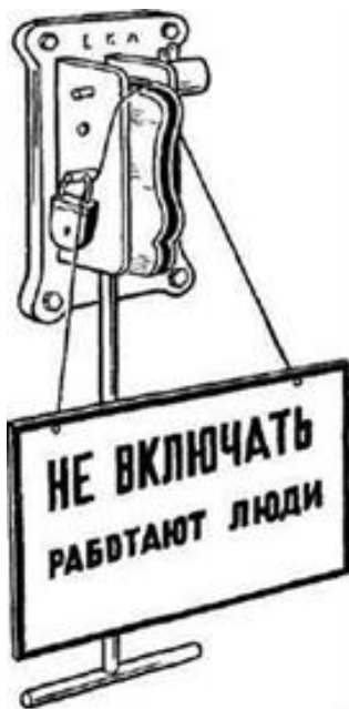
Рисунок 9.1 – Ручной привод разъединителя, запертый на замок в отключенном положении
