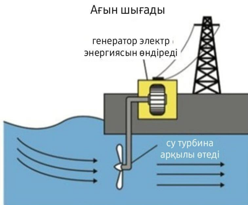
4.7 сурет – Ағын энергиясынан электр энергиясын өндіретін су электр станциясы
