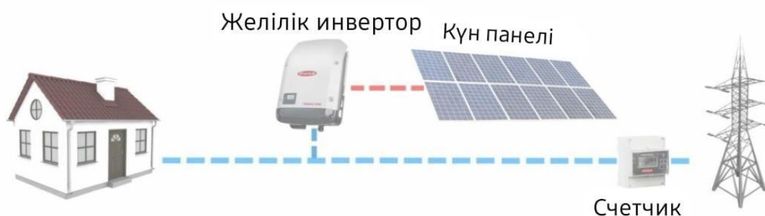
2.2 сурет – Желілік күн электр станциясы
