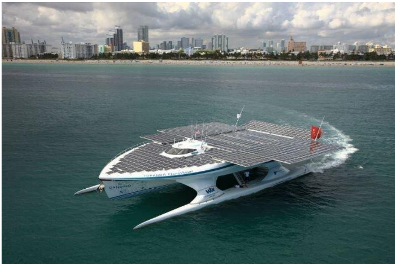
2.30 сурет – Швейцарияда жасалған Planet Solar деп аталатын күн көзінен қуат алатын кеме
