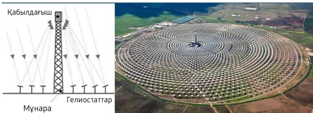
2.7 сурет – Мұнара типті күн электр станциялары
