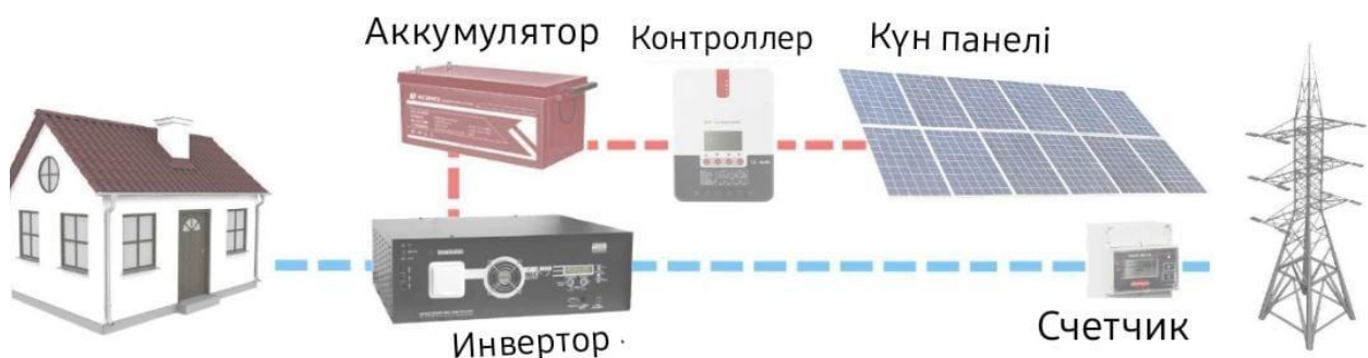
2.5 сурет – Гибридті электр станциясы
