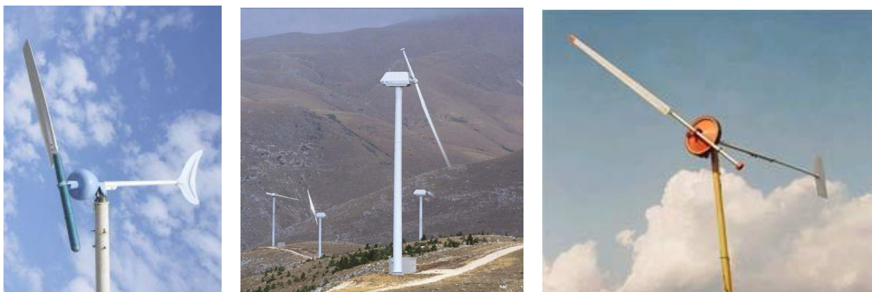
3.25 сурет – Бір қалақшалы жел генераторы
