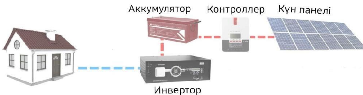
2.3 сурет – Автономды күн электр станциясы
