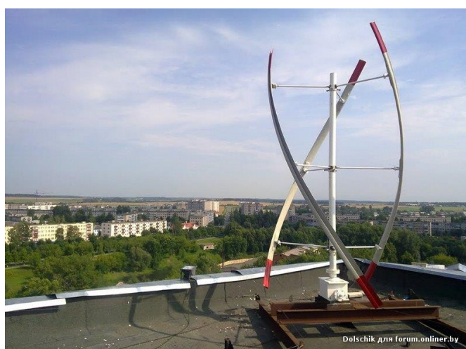
3.21 сурет – Геликоидты роторлы тік осьті жел генераторы
