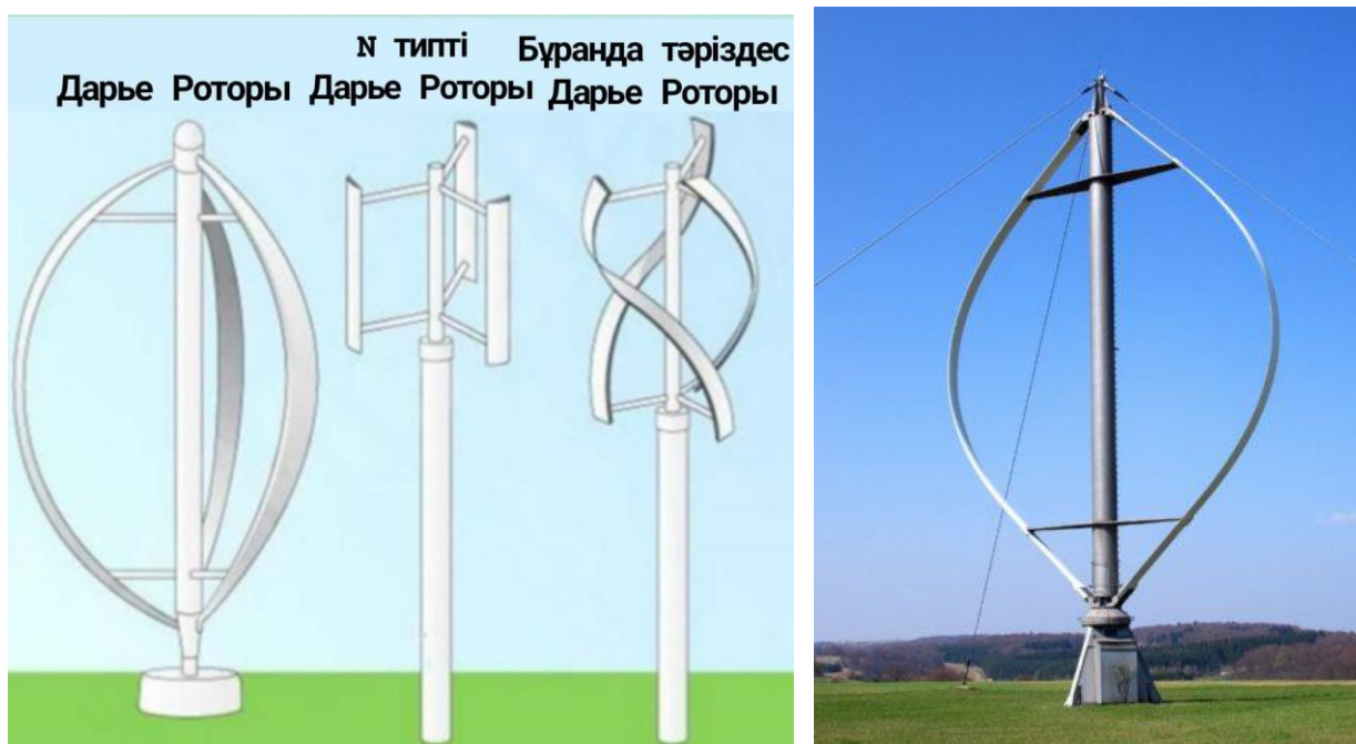
3.19 сурет – Дарье роторлы тік осьті жел генераторы
