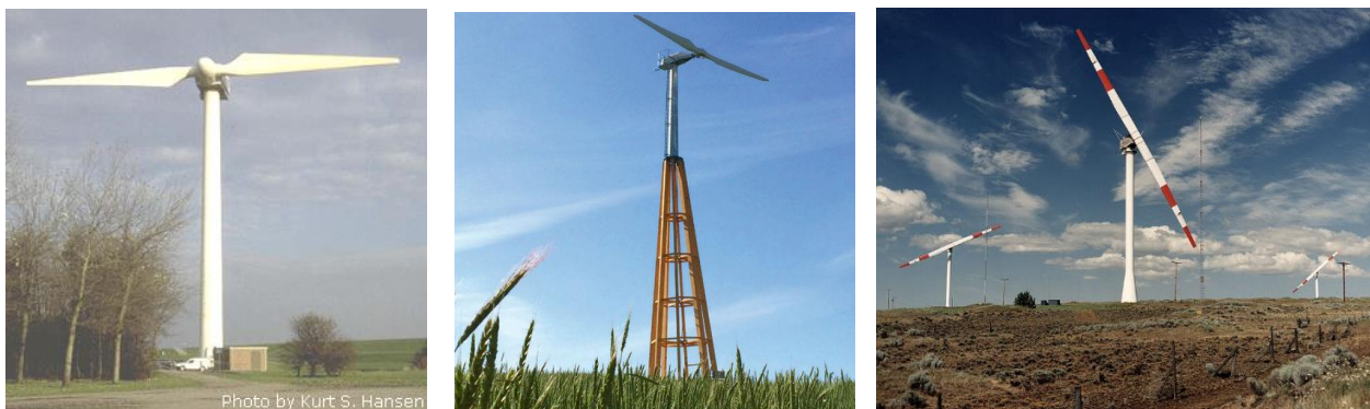
3.26 сурет – Екі қалақшалы жел генераторы
