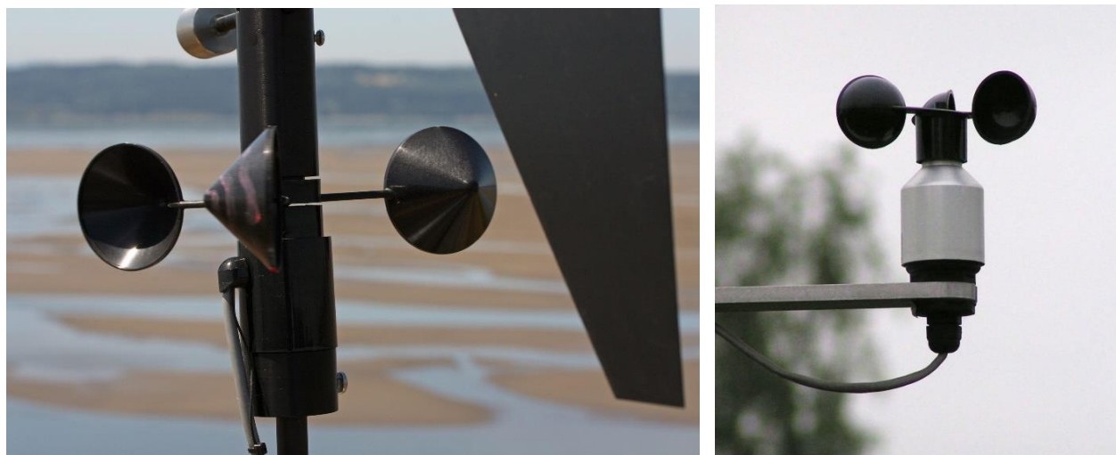
3.4 сурет – Табақтық анемометрдің сыртқы көрінісі және оның метеостанцияда орнатылуы
