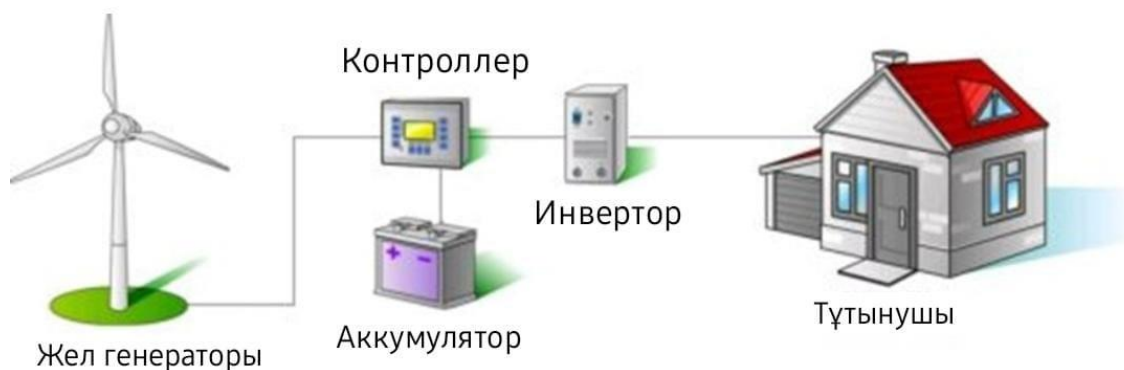
3.15 сурет – Жел генераторымен бірге жұмыс істейтін қондырғылар
