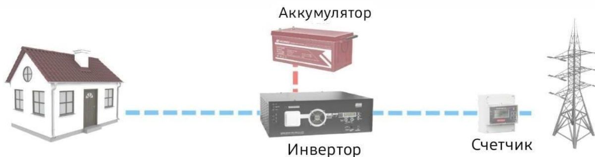
2.6 сурет – Резервтік электрмен жабдықтау жүйесі
