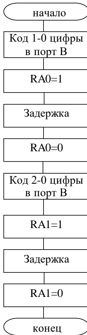
Рисунок 8 – Блок-схема временной диаграммы управления динамической индикацией
