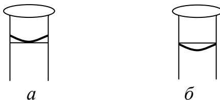
1 сурет – Колба бөлігімен түйіскен ойығы түссіз ерітінділер үшін (а), боялған ерітінділер үшін (б)
