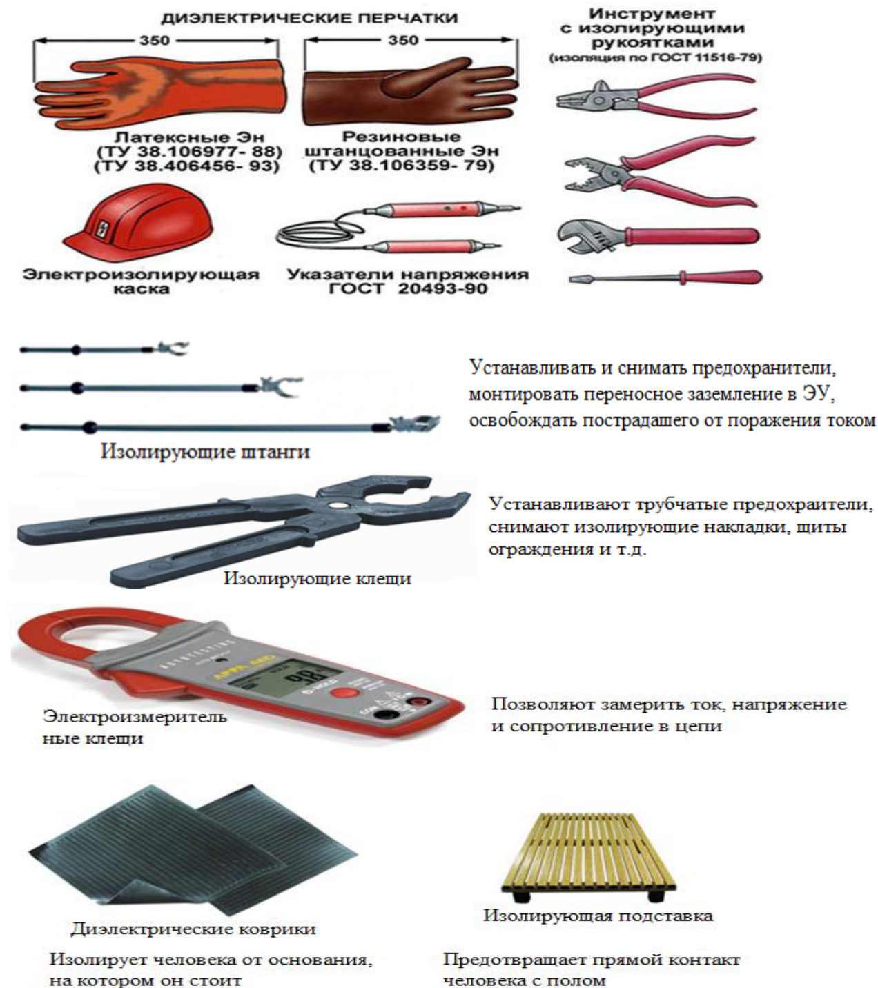
Рисунок 4.1 – Средства защиты, применяемые при эксплуатации электроустановок
