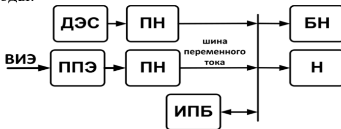
Рисунок 14.3 – Гибридный энергетический комплекс с шиной переменного тока и инверторной ДЭС
