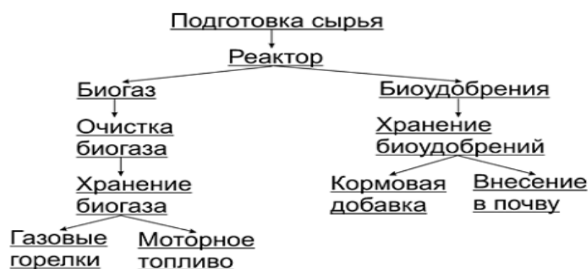
Рисунок 11.3 – Схема переработки органических отходов на биогазовых установках
