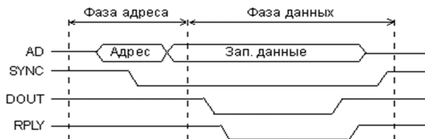
2.4 –сурет. Q-bus магистралына жазу циклі
