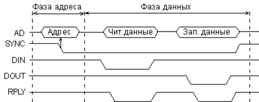
2.5 –сурет. Q-bus магистралындағы «енгізу-пауза-шығару» циклі
