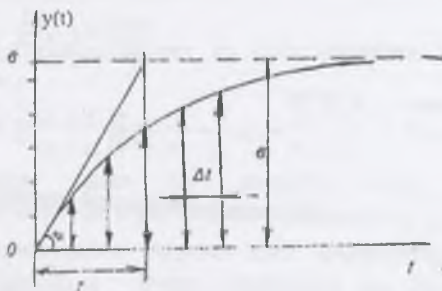
Рисунок 2.1 - К определению уравнения объекта первого порядка по кривой разгона
