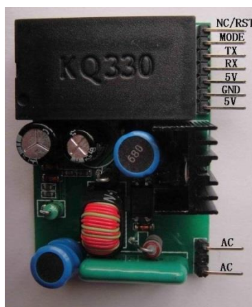
Рисунок 3.1 – Внешний вид модуля модулятора KQ-330F
