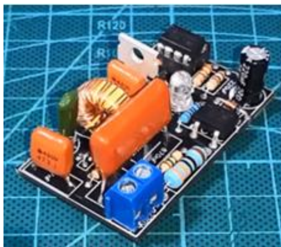
Рисунок 5.8 – Внешний вид платы передатчика
