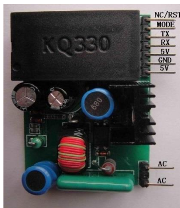
Рисунок 2.1 – Внешний вид модуля модулятора KQ-330F
