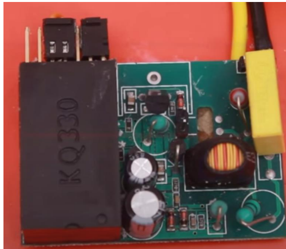
Рисунок 1.2 – Вид PLC-адаптера на базе KQ-330F
