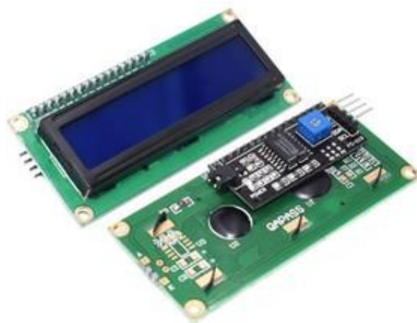
Рисунок 3.4 – Внешний вид LCD 1602 I2C дисплея
