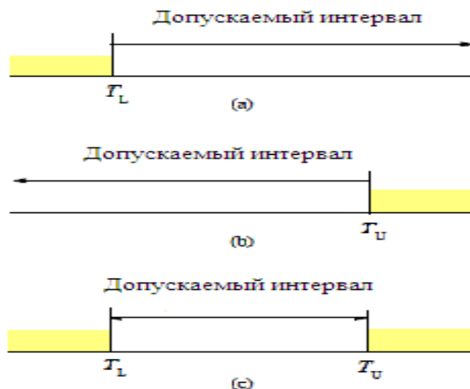
Рисунок 7.1 – Графическое представление интервала допуска или допускаемого интервала
