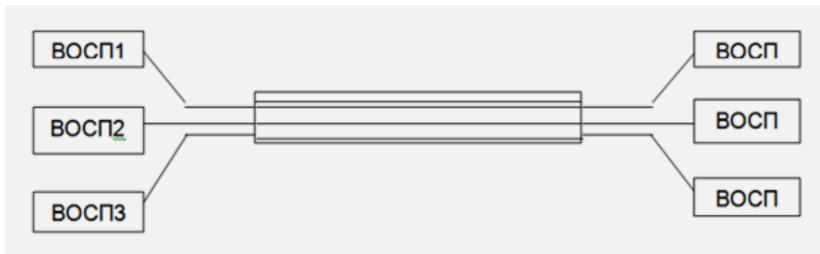
Рисунок 7.3 – Схема пространственного уплотнения ВОЛС
