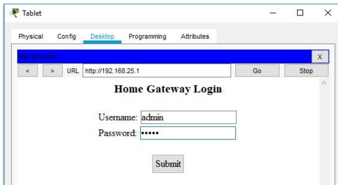
Рисунок 3.11 – Окно «Планшета» для записи конфигураций шлюза
