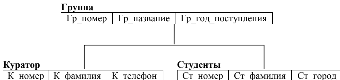
Рисунок 2.1 - Пример типа дерева (схема иерархической БД)
