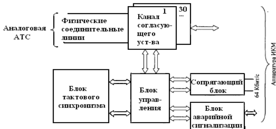
Рисунок 7.2 – Схема согласующего устройства
