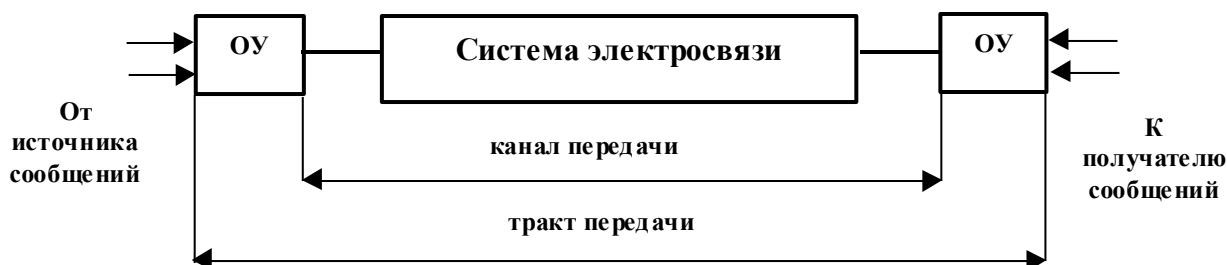
Рисунок 1.1- Структурная схема системы электросвязи (телекоммуникационной системы)
