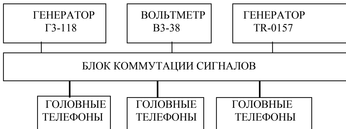
Рисунок 4.1- Структурная схема аппаратного комплекса для изучения явления маскировки звука и снятия зависимости звукового давления равной громкости от частоты
