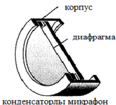
2.2 сурет- Конденсаторлық микрофон құрылғысы
